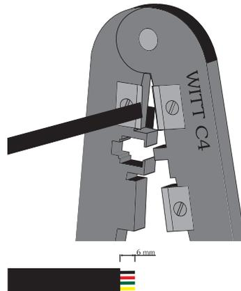
3. Kabel in gezeigter Farbreihenfolge in den richtig positionierten Stecker einlegen.
